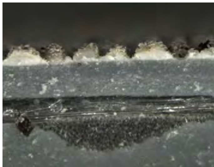
Obr. č. 4 – Detail předchozího, kde je patrné, jak tenká vrstva odolná proti UV záření je totálně zdestruovaná
