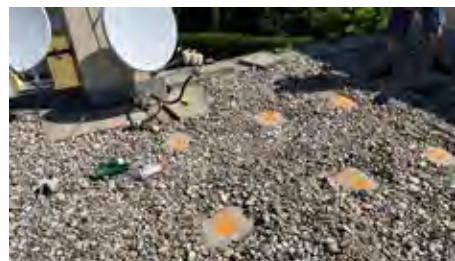
(sondové meranie vlhkosti na streche zasypanej štrkom)
