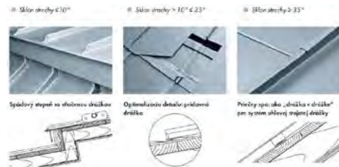
Obr. č. 15 - Ukážka spoľahlivých priečných dilatačných spojov v závislosti od strešného sklonu. Zdroj: Technologický predpis RHEINZINK GMBH.
