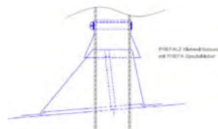
Obr. č. 22 - Ukážka oplechovania bodového prestupu lepením. Zdroj: Technologický predpis PREFA ALUMINIUMPRODUKTE.
