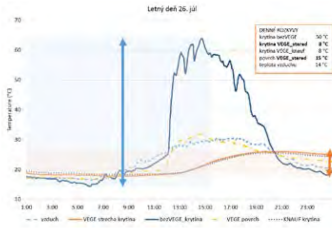
Obr. 5. Denný priebeh teplôt na dvoch vegetačných strechách a streche s nechránenou povlakovou krytinou po nočnom daždi – výrazné zníženie rozkvyvu pri vegetačných strechách
