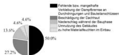
Obr. 6: 22 případů škod u 1-plášťových plochých střech dřevostaveb v Rakousku, B.Nusser, HFA, 2017
