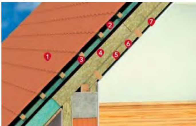
Ob. 4 Zateplení šikmé střechy mezi a pod krokve izolacemi z kamenné vlny ROCKWOOL
