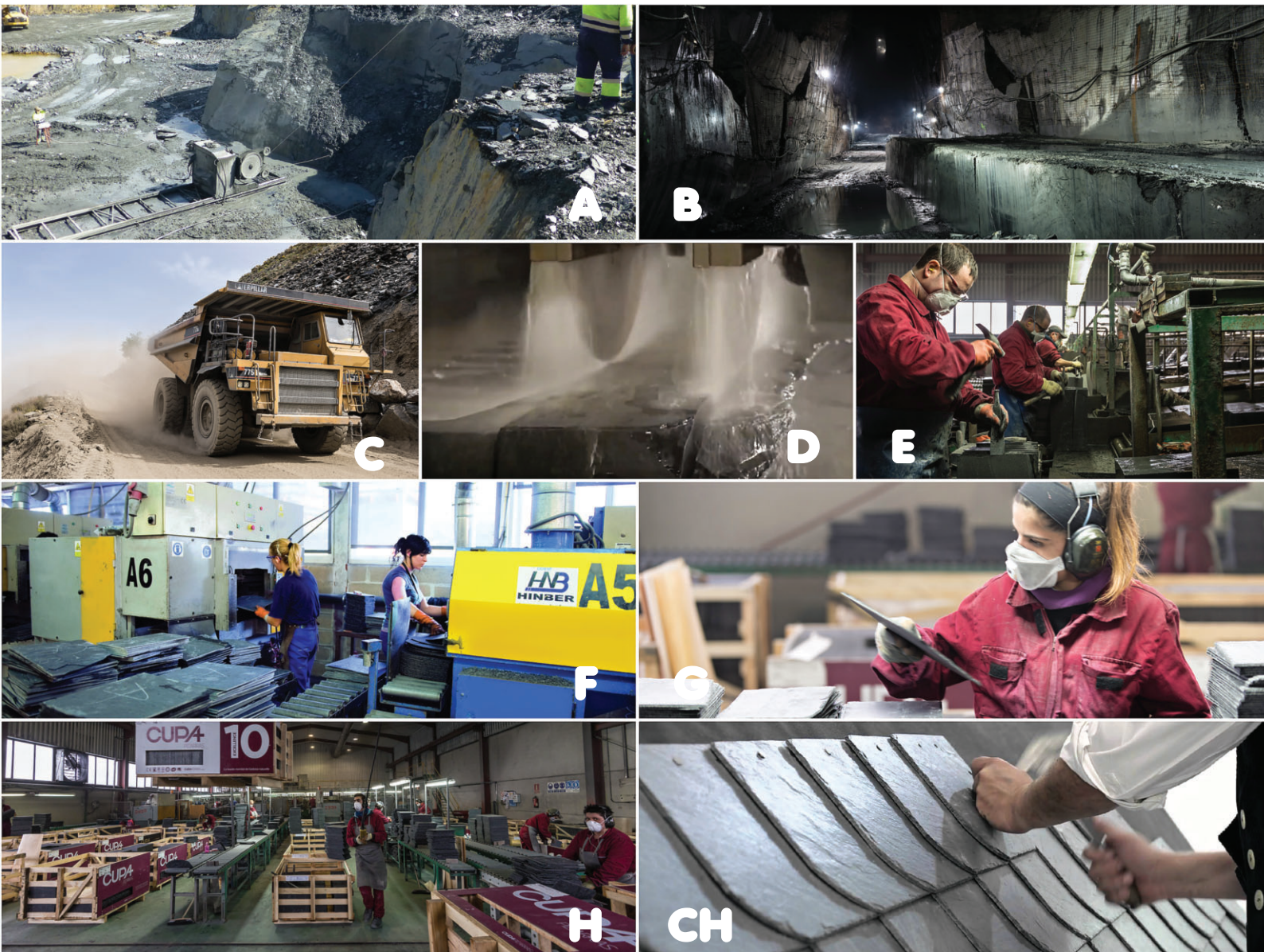
Obr. 2. Proces výroby pokrývačskej bridlice. Zdroje fotografií so súhlasom: Be natural, Cupa Pizarras, Ratscheck
