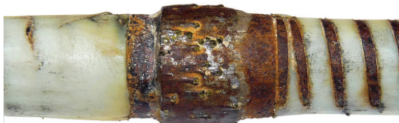
Obr. 4 Priemyselné diamanty na krúžku rezného lana - detail
