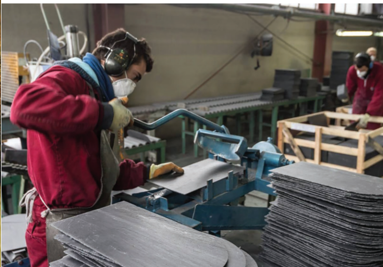
Obr. 5 Ručné osekávanie základného formátu na finálny formát strešnej krytiny Zdroj: Cupa Pizarras, Španielsko
