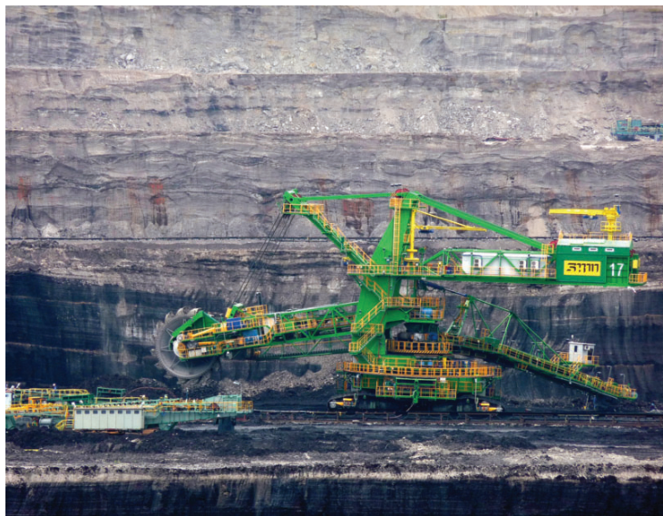
Povrchová ťažba hnedého uhlia - lignitu. Aby sme sa dostali k hrubým slojom uhlia, je potrebné odstrániť desiatky až stovky metrov nadložných hornín. Ložisko Bogatynia - Turów v južnom Poľsku. Ročná ťažba predstavuje 10 - 11 mil. ton. Foto: J. Madarás
