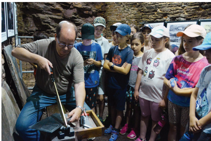
Ukážka výroby bridlicového srdiečka na pákových nožniciach (foto: Ivan Paška)
